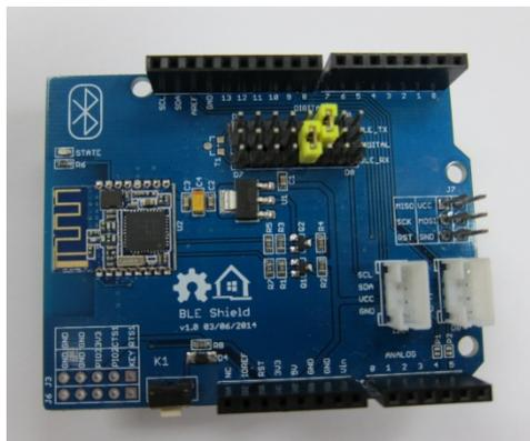
圖 4.3 BLE Shield v1 低功耗 Bluetooth4.0 傳輸模組
