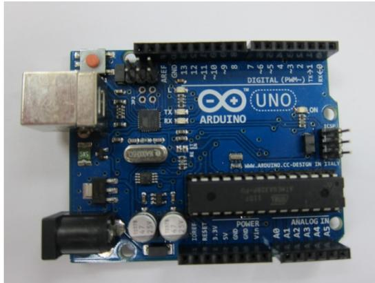
圖 4.2 Arduino UNO Rev3 微控制器
